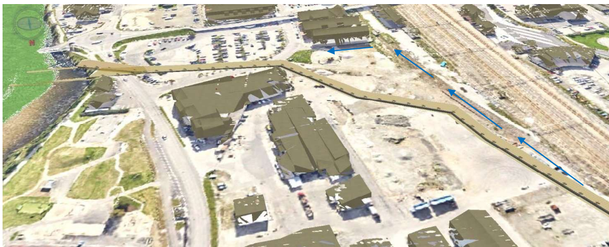
Figur 15: Eksisterende overvannsledning som leder overvann til G5, sett fra luften mot sør. Flomveien langs jernbanen er skissert inn med blå piler.
