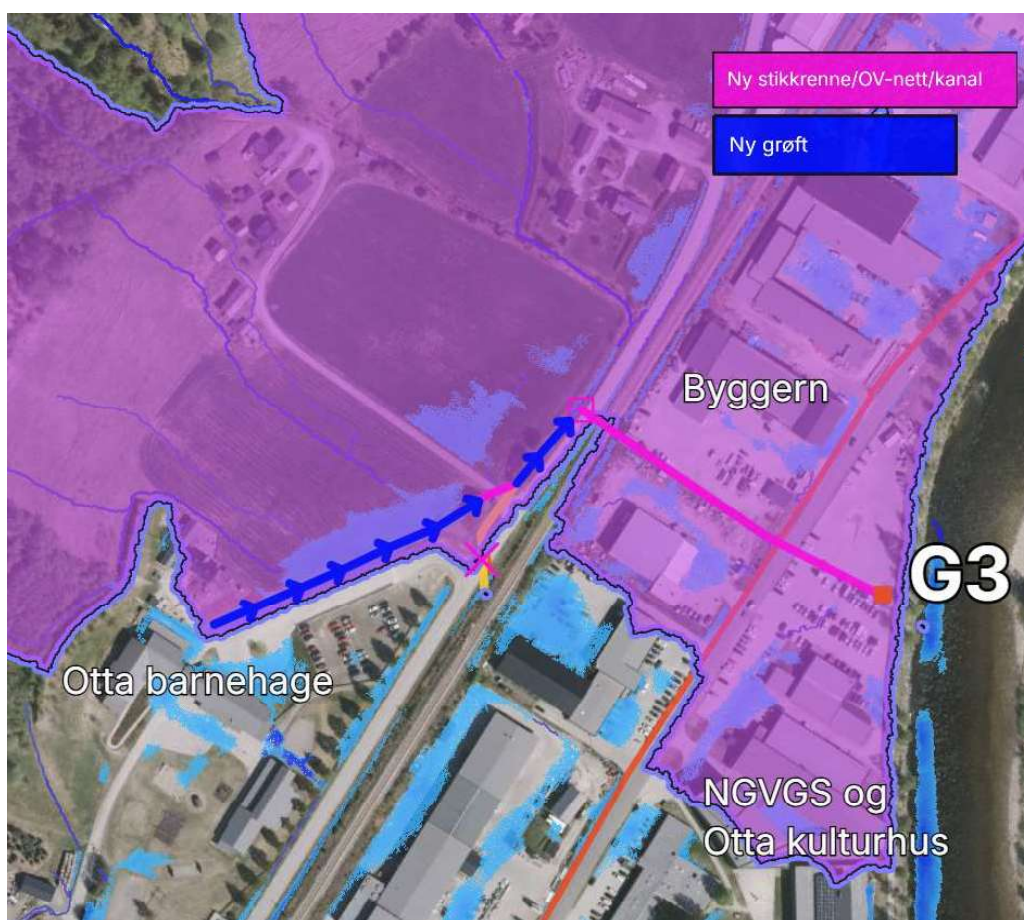
Figur 8: Foreslåtte tiltak for å lede overvann til pumpestasjon G3. Blå piler indikerer åpen grøft. Magenta strek fra jernbanen til G3 indikerer overvannsanlegg for overflatevann parallelt med Kleivrudbekken i rør (ikke vist). Dersom Kleivrudbekken utføres som åpen løsning vil overflatevannet føres til den åpne Kleivrudbekken.
