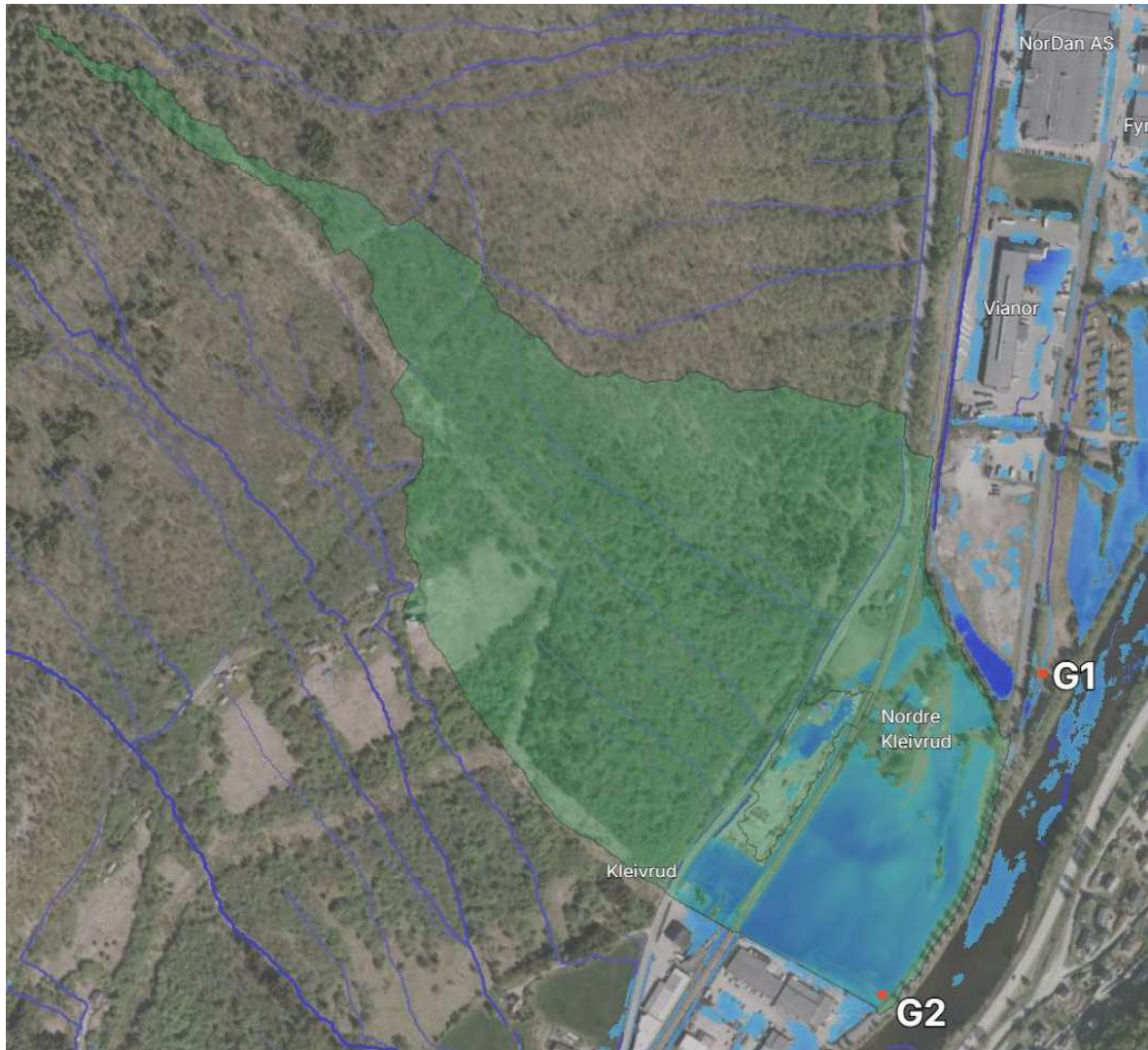
Figur 7: Nedbørfelt som drenerer til pumpestasjon G2.
